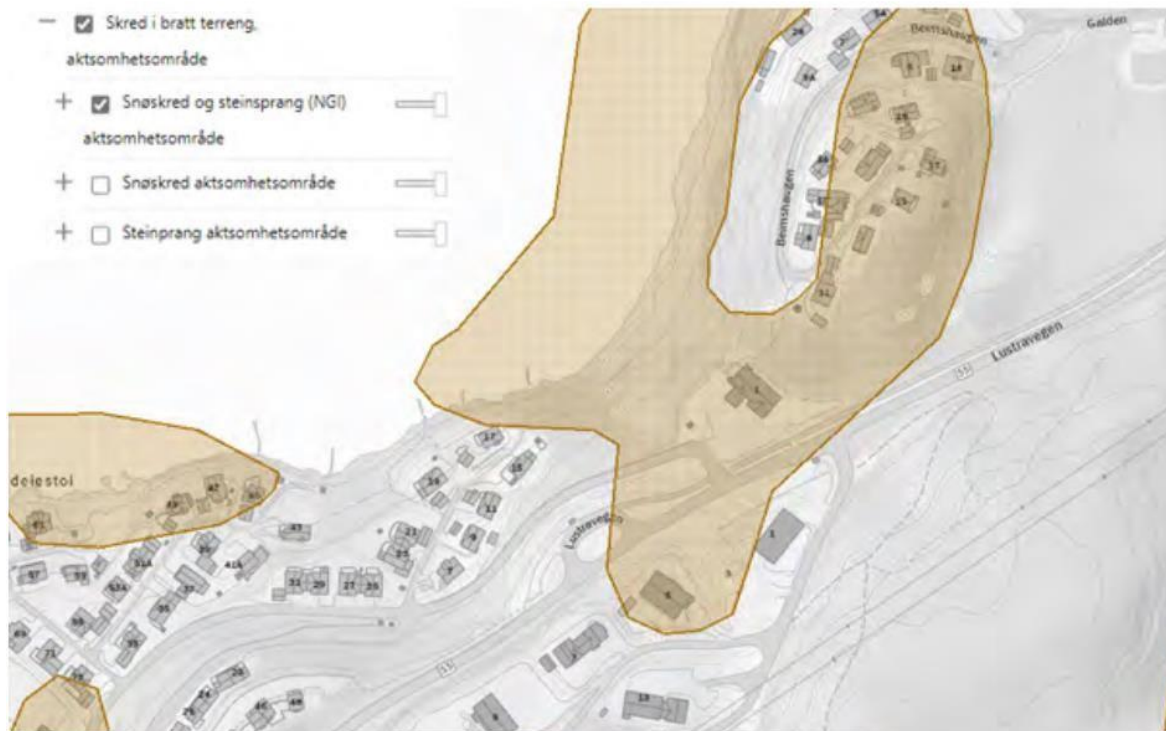
Figur 1. I områder med dekning av NGI sitt aktsemdskart, kan dette kartlaget nyttast framfor "snøskred aktsomhetsområde" og "steinsprang aktsomhetsområde".
